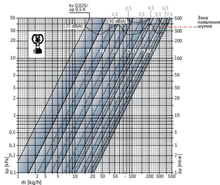
Гидравлическая характеристика вентиля Н без предварительной настройки
