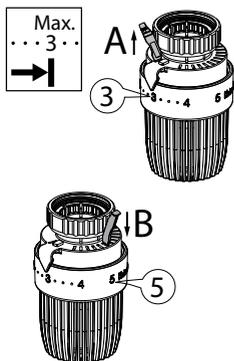
Для ограничения МАКСИМАЛЬНОЙ температуры установите головку на желаемую максимальную температуру. Например, установите стрелку на отметку 3, что соответствует 20 °C комнатной температуры.
