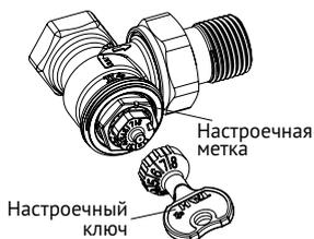
Конструкция вентилей позволяет настроить (сбалансировать) систему отопления.
